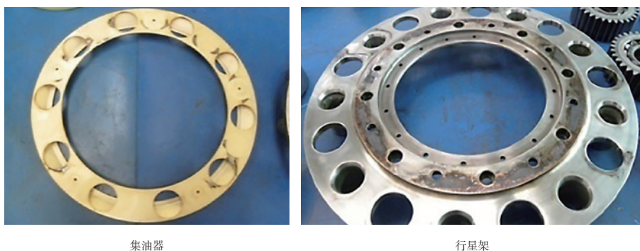
图1 集油器与行星架配合面腐蚀示意图
