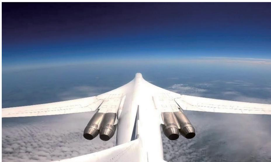
图-160M换装NK-32-02发动机
