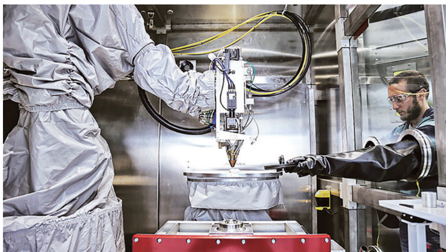
比传统的焊接和热喷涂更有优势的冷喷涂修理技术
