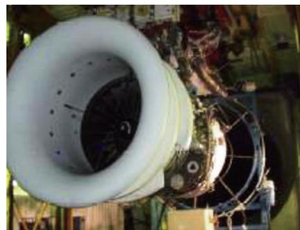
图5 GENx发动机污染排放试验
