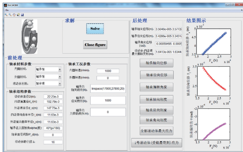
图4 以创新性算法为基础开发出的轴承性能参数计算工具
