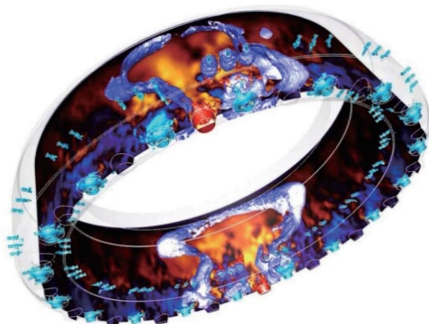
图1 燃烧室内部燃烧过程大涡模拟结果
